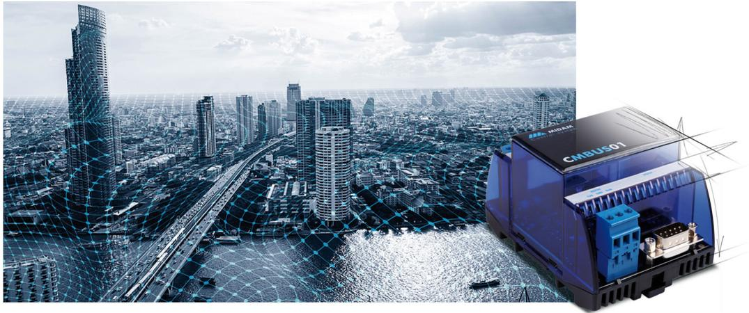
Convertidor de la capa física M-Bus controlado por microprocesador para la lectura de aparatos de medición como contadores de energía, contadores de agua fría y caliente, sensores, etc. El convertidor soporta cambio de velocidad de transmisión automático y hasta 60 cargas M-Bus, generalmente 60 contadores. Este dispositivo convierte la señal M-Bus a RS232 y dispone de varias posibilidades de conexión para este puerto.
