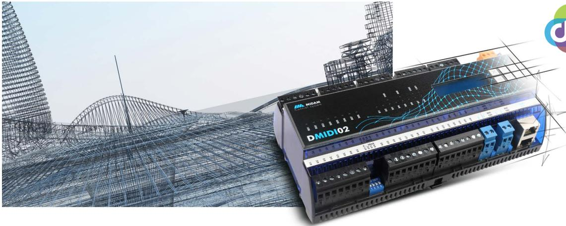
Controlador libremente programable equipado con procesador i.MX RT y sistema operativo FreeRTOS. Adecuado para el control y toma de datos en instalaciones HVAC e industriales. Equipado con dos puerto Ethernet y dos puertos RS485, 8EA (universal/configurable), 6SA, 8ED y 8SD así como servidor web integrado. La pantalla retroiluminada y los botones hacen que el controlador sea fácil de manejar localmente.
