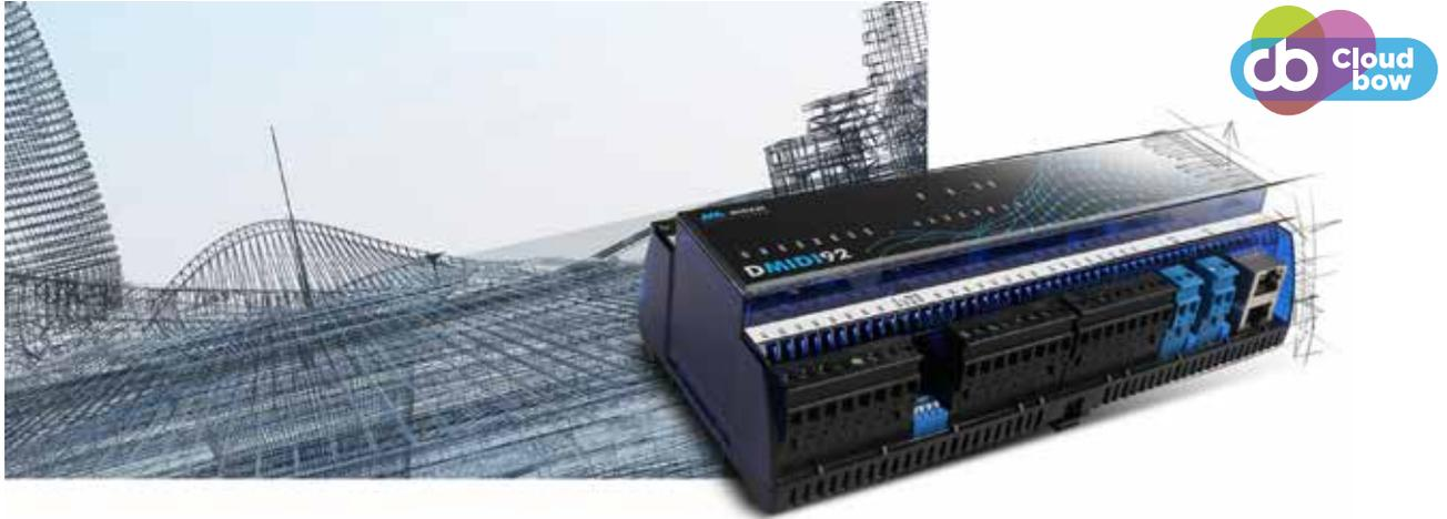
Controlador libremente programable equipado con procesador i.MX RT y sistema operativo FreeRTOS. Adecuado para el control y toma de datos en instalaciones HVAC e industriales. Equipado con dos puerto Ethernet y dos puertos RS485, 8EA (universal/configurable), 6SA, 8ED y 8SD así como servidor web integrado.
